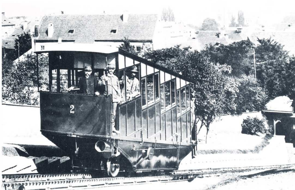
Tak vypadaly vozy první petřínské lanovky z roku 1891 poháněné systémem vodní převahy. Vyrobila je firma Ringhoffer.
