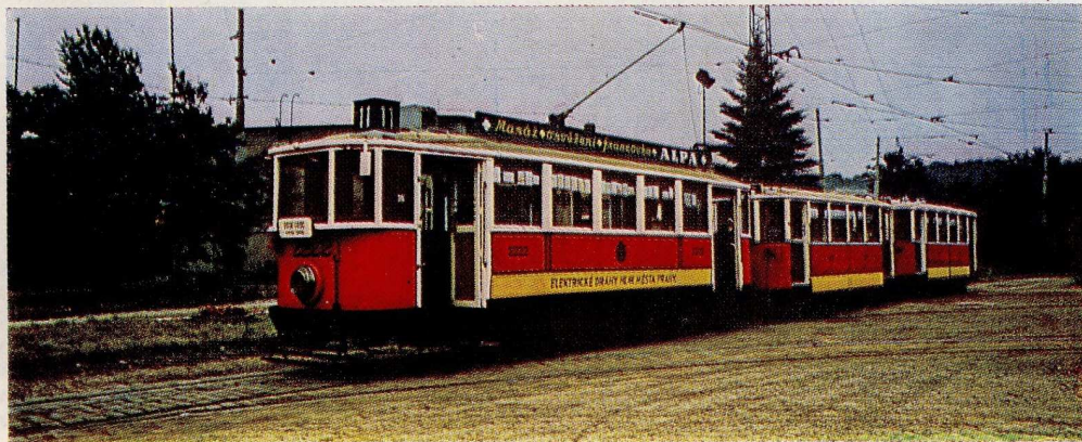
Elektrický motorový vůz elektrických drah z roku 1930. Na snímku se dvěma vlečnými vozy typu „plecháč“. Vzhled soupravy z třicátých let. Pražanům sloužil do roku 1974
