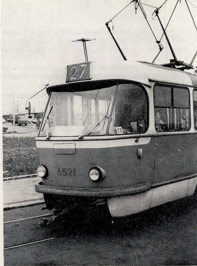
Na střechách pražských tramvají přibývají antény vysílaček
